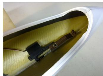
Jetzt kann der gesamte Grundkörper samt Messingrohr(e) mit Endfest 300 im Rumpf verklebt werden.
